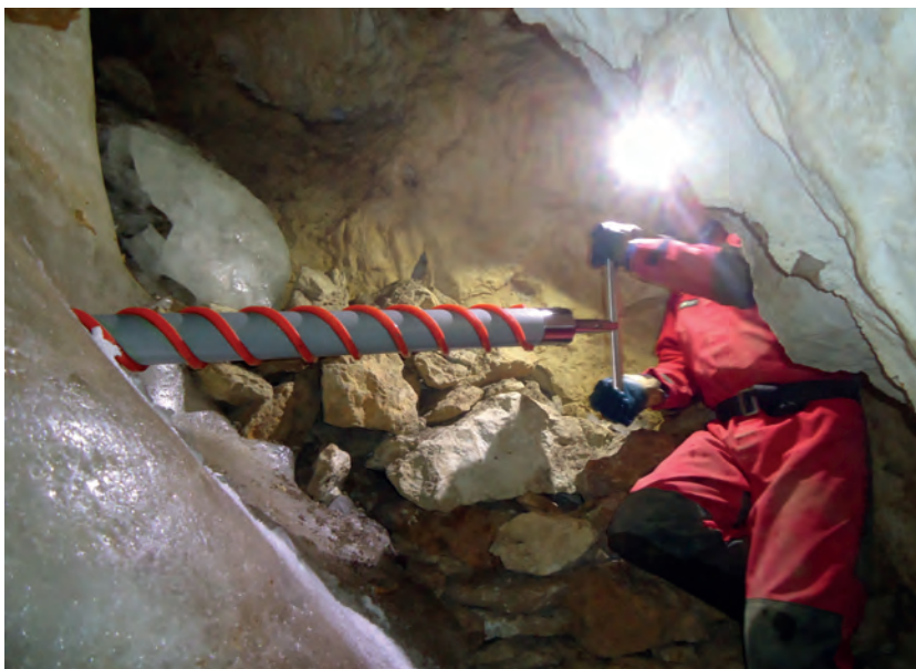
Abb. 2: Eiskernbohrung am Tiefsten Punkt. Fig. 2: Ice-core drilling at Tiefsten Punkt.
