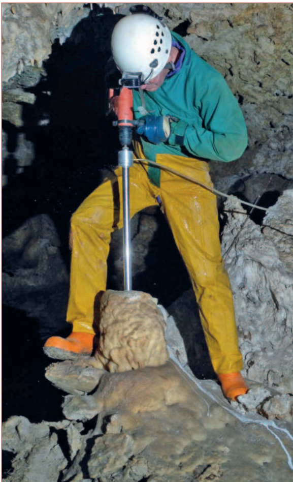
Abb. 3: Kernbohrung (mit Wasserspülung) in den Stalagmiten KRA5.
