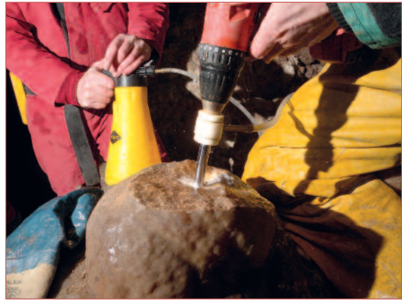
Abb. 4: Der zentrale Stalagmit KRA6a einer Tropfsteingruppe ist ebenfalls nur noch als Torso erhalten. Die Analyse eines Bohrkernes ergab, dass sein Wachstum vor etwa 42 kyr begann.
